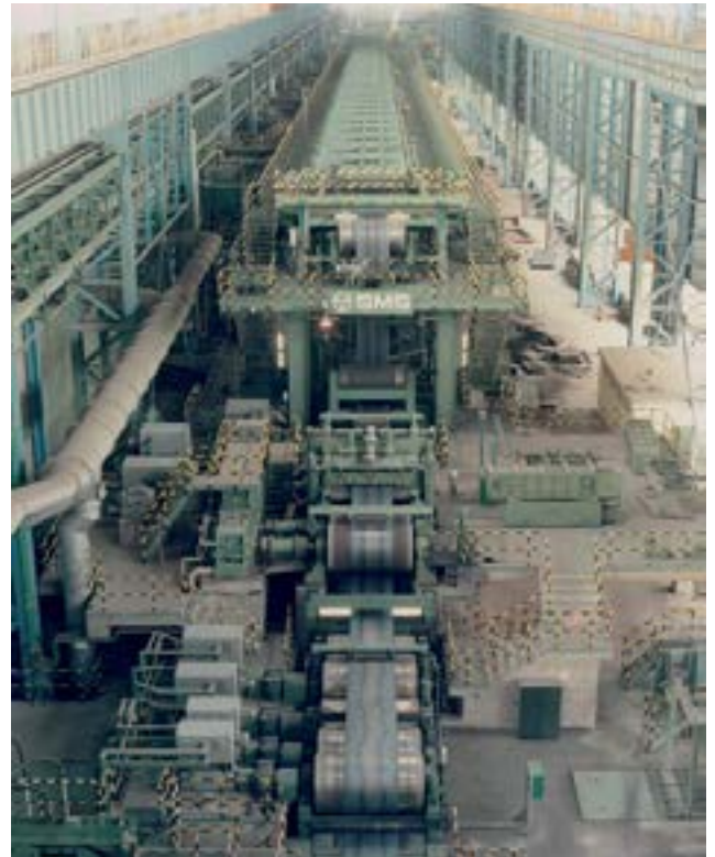
SMS-Beizanlage zum Behandeln von Warmband, 1980er Jahre
