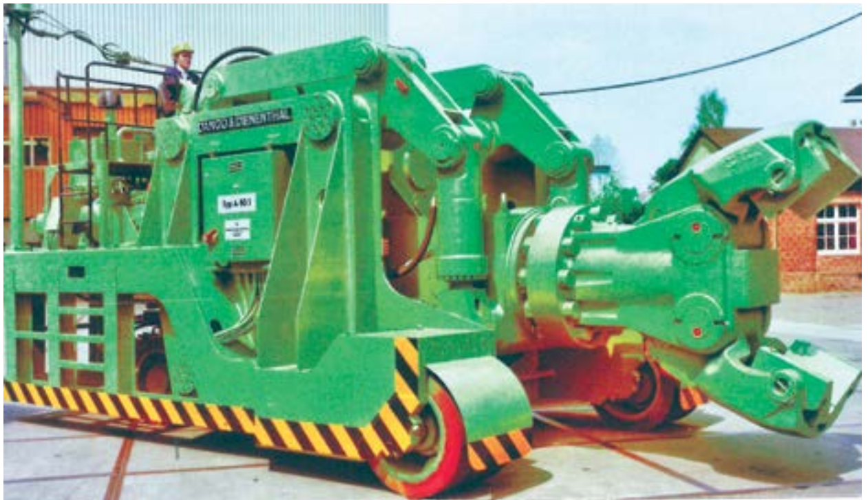
Frei fahrbarer großer Schmiedemanipulator für eine Traglast von 20 t, um 1980.
